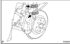
6. LOOSEN 2 NUTS ON LOWER SIDE OF SHOCK AB-SORBER
